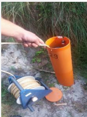
Pomiar głębokości występowania zwierciadła wód podziemnych
